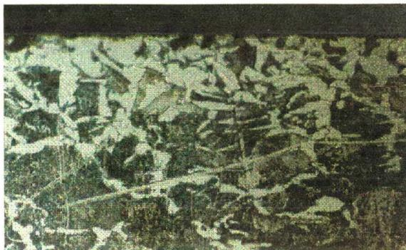
Figura 42 - Aço AISI 1045 tratado em descarga Ar-O<sub>2</sub> (1%), com temperatura desconhecida. (8x25).
