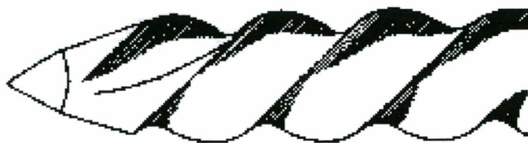
Figura 3.16 - Desenho esquemático da lima Flex-R .
