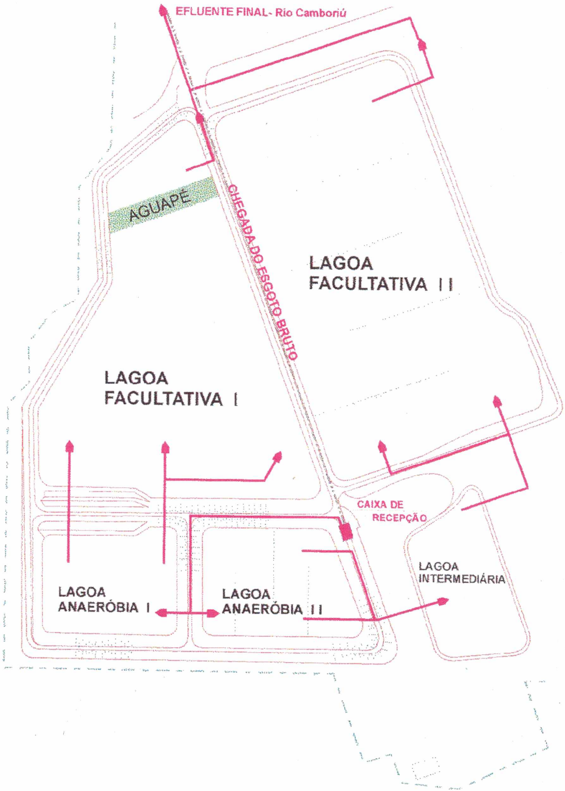
Figura 7 - Lay-Out das Lagoas de Estabilização
