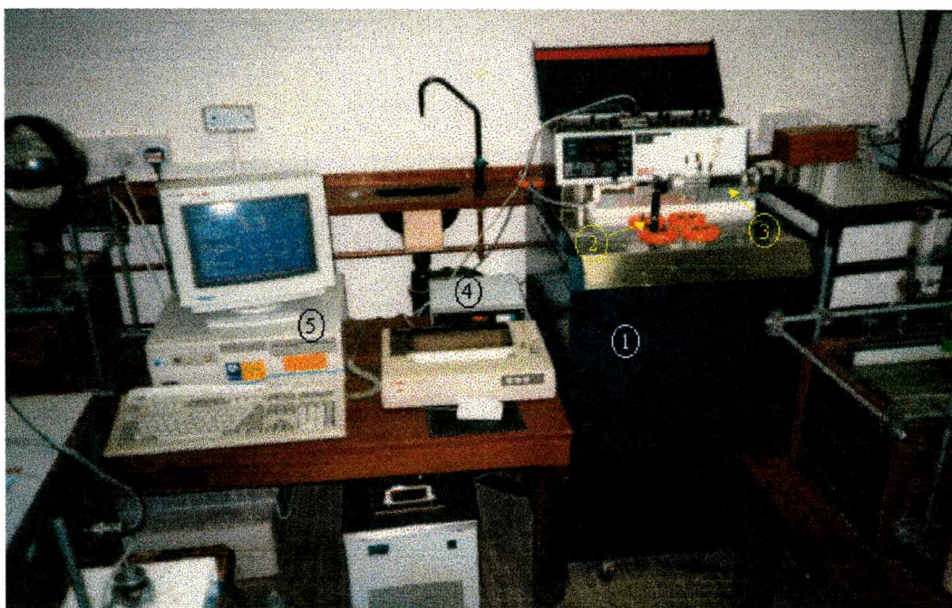
Figura 6: Apararelhagem utilizada nas medidas calorimétricas: (1) microcalorímetro TAM; (2) unidade de titulação; (3) seringa; (4) controle da seringa; (5) controle do experimento.
