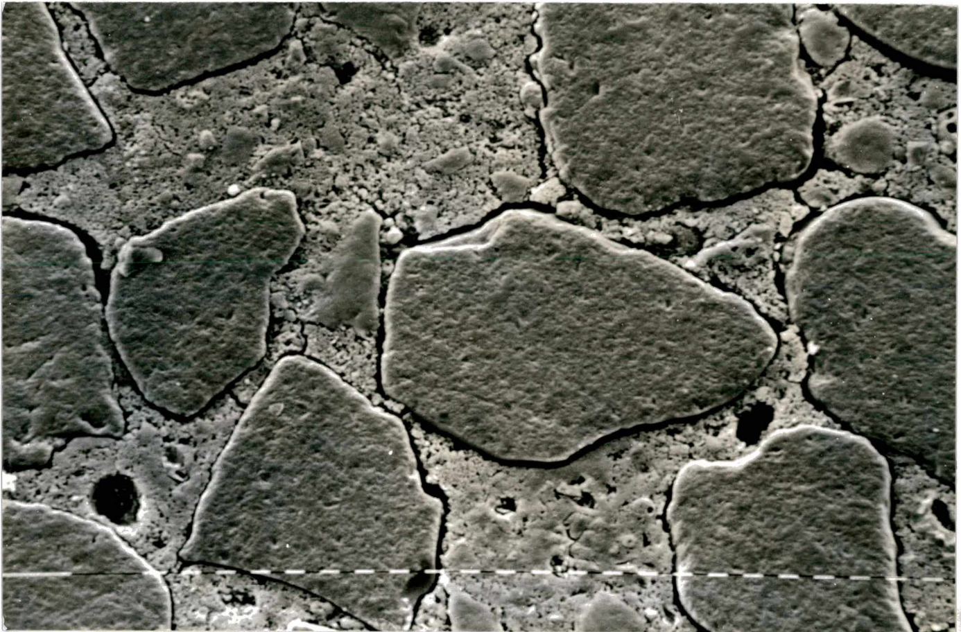
Figura 4.4 Micrografia da argamassa de cimento e cal. Ampliação 200 X. Escala 10 \mu\text{m} . Amostra polida.
