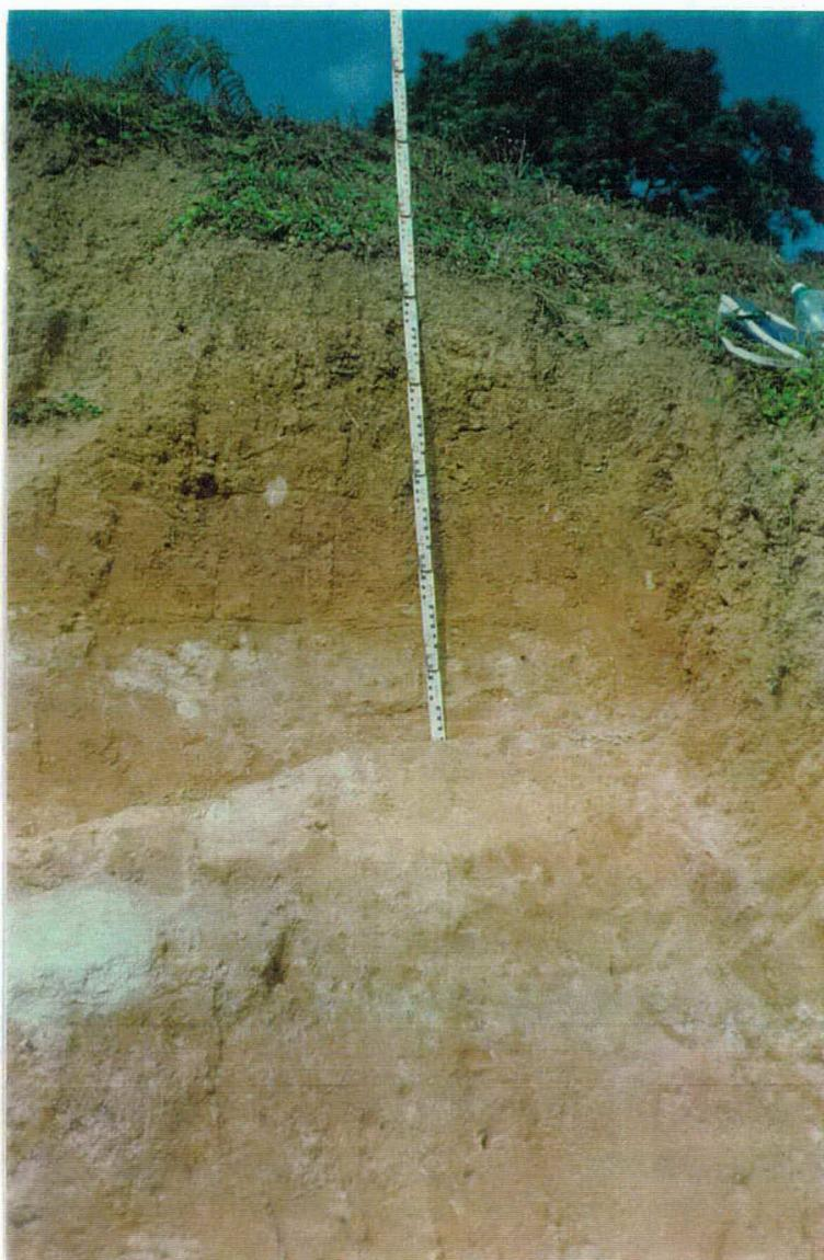
Foto 13 - Visão da parede da cicatriz. Nota-se a presença dos horizontes característicos do solo e a passagem para o volume da rocha alterada com estrutura conservada. Nesse volume, existem grãos de feldspato alterados fornecendo coloração clara ao material em certos pontos.
