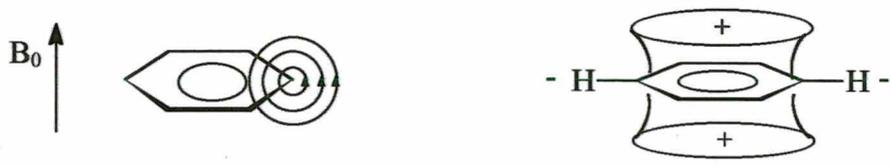
**Figura 2.** Esquema explicativo do efeito da corrente no anel, destacando-se as regiões de blindagem (+) e desblindagem (-).
