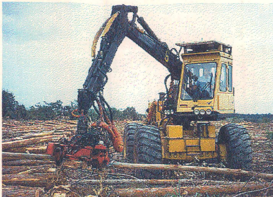
Figura 4.1 - Trator Harvester em ação no ambiente florestal.
