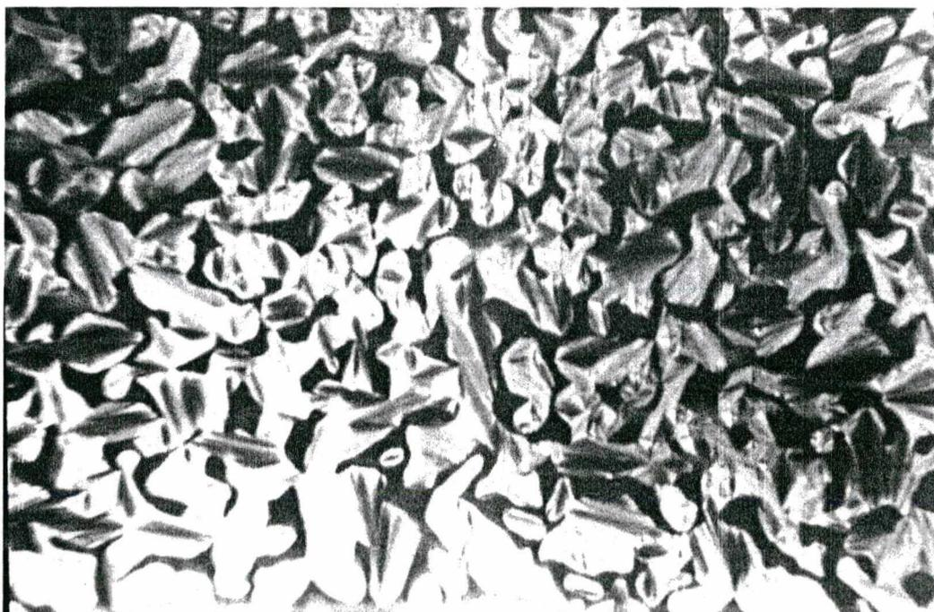
Figura 20 - Mesofase  $S_A$  focal-cônica do composto 5-(4-nitrofenil)-3-(4-heptiloxifenil)-1,2,4-oxadiazol na temperatura de  $153,0^{\circ}\text{C}$ . Aumento 40x.
