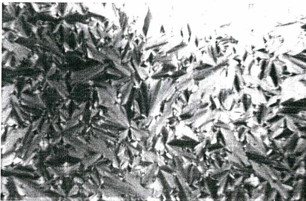
Figura 23 - Mesofase  $S_A$  focal-cônica do composto 3-[2-(5-butiltienil)]-5-(4-nitrofenil)-1,2,4-oxadiazol, na temperatura de 88,5°C. Aumento 40x.
