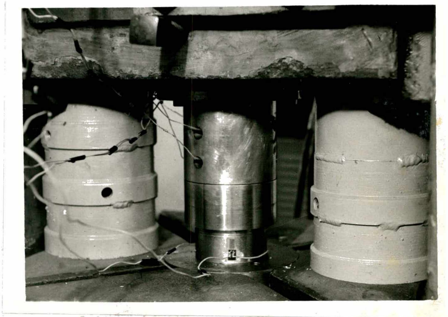
FIG. 17 - Vista do conjunto das matrizes montadas à prensa.
