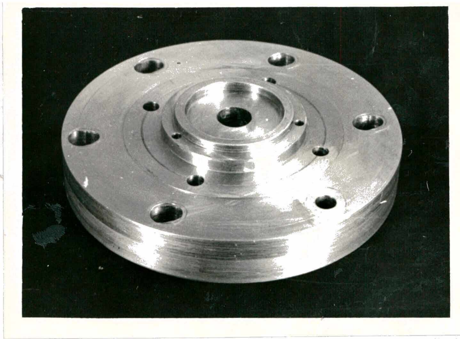
FIG. 26 - Detalhe do disco guia (6).
