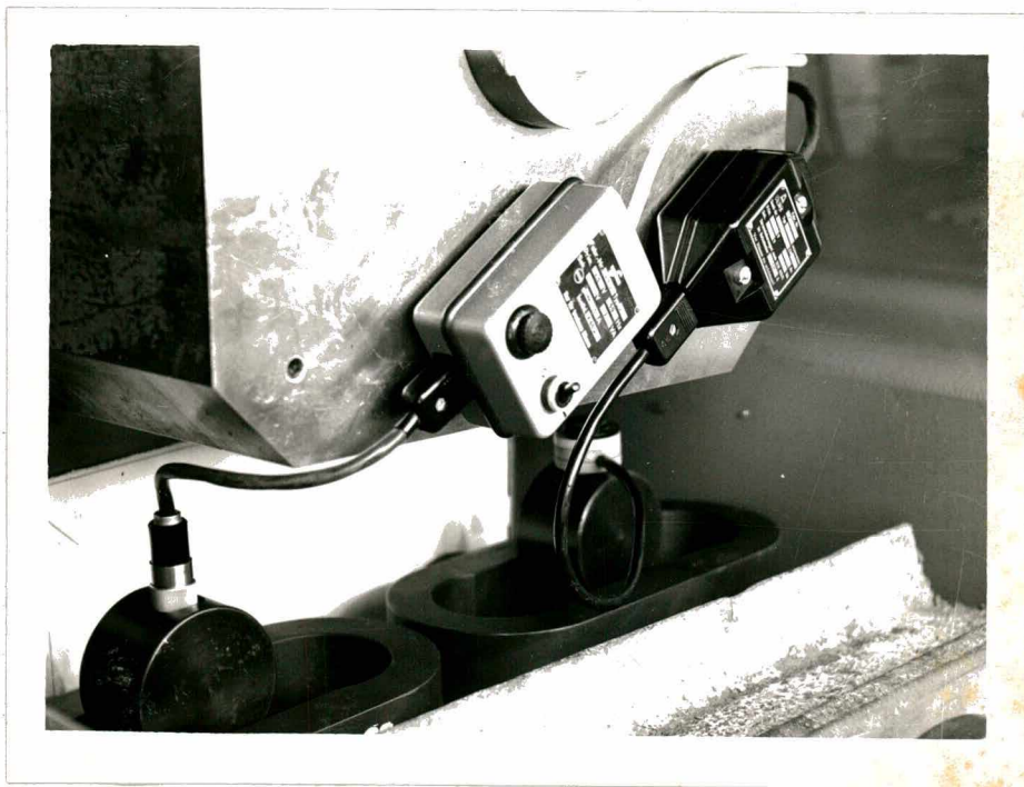
FIG. 40 - Vista da fonte de tensão de alimentação das lâmpadas elétricas de iluminação das escalas dos microscópios.
