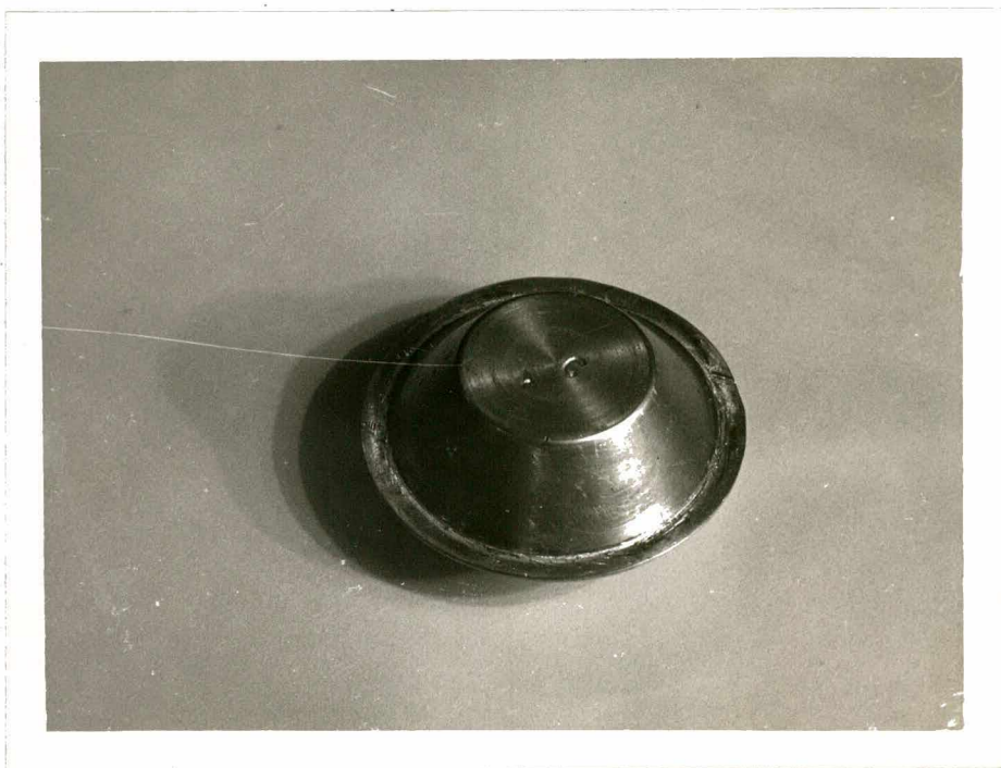
FIG. 50 - Vista do forjado obtido por forjamento.
