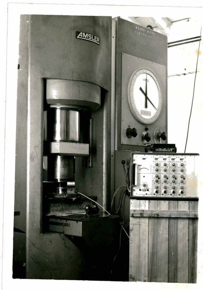
FIG. 42 - Vista geral da montagem para calibração do anel/ de medição da força P .
