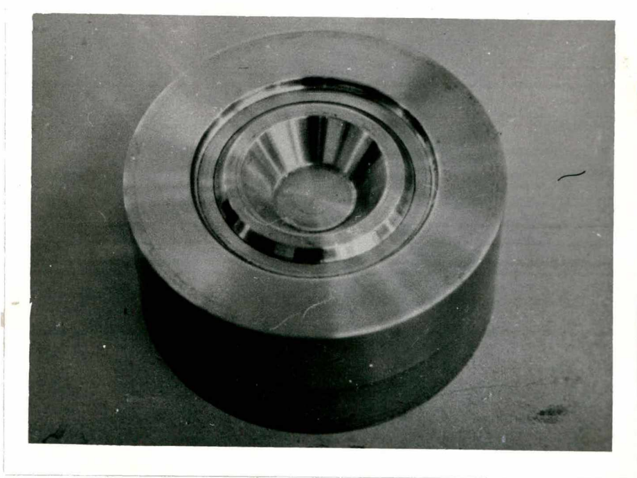
FIG. 28 - Detalhe da matriz propriamente dita (8), (vis ta de cima).
