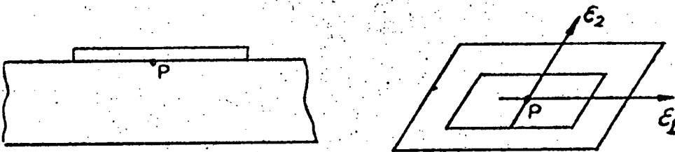
Figura 31: Transmissão das deformações da peça para o revestimento.
