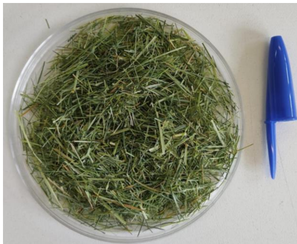
Figura 11 – Amostra de capim de Tifton 85 ( Cynodon sp. ) após etapas de secagem e trituração, apresentando-se com fragmentos grandes, finos, alongados e pontiagudos.
