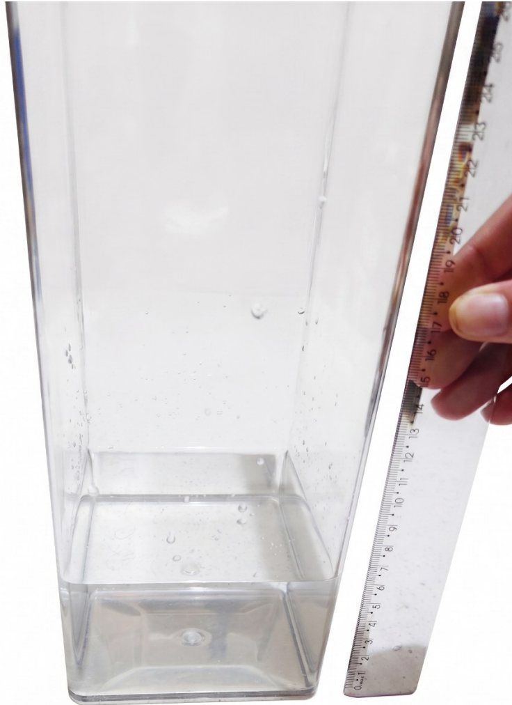
Figura 20 – Primeira medição do nível da água com a régua: 6 cm
