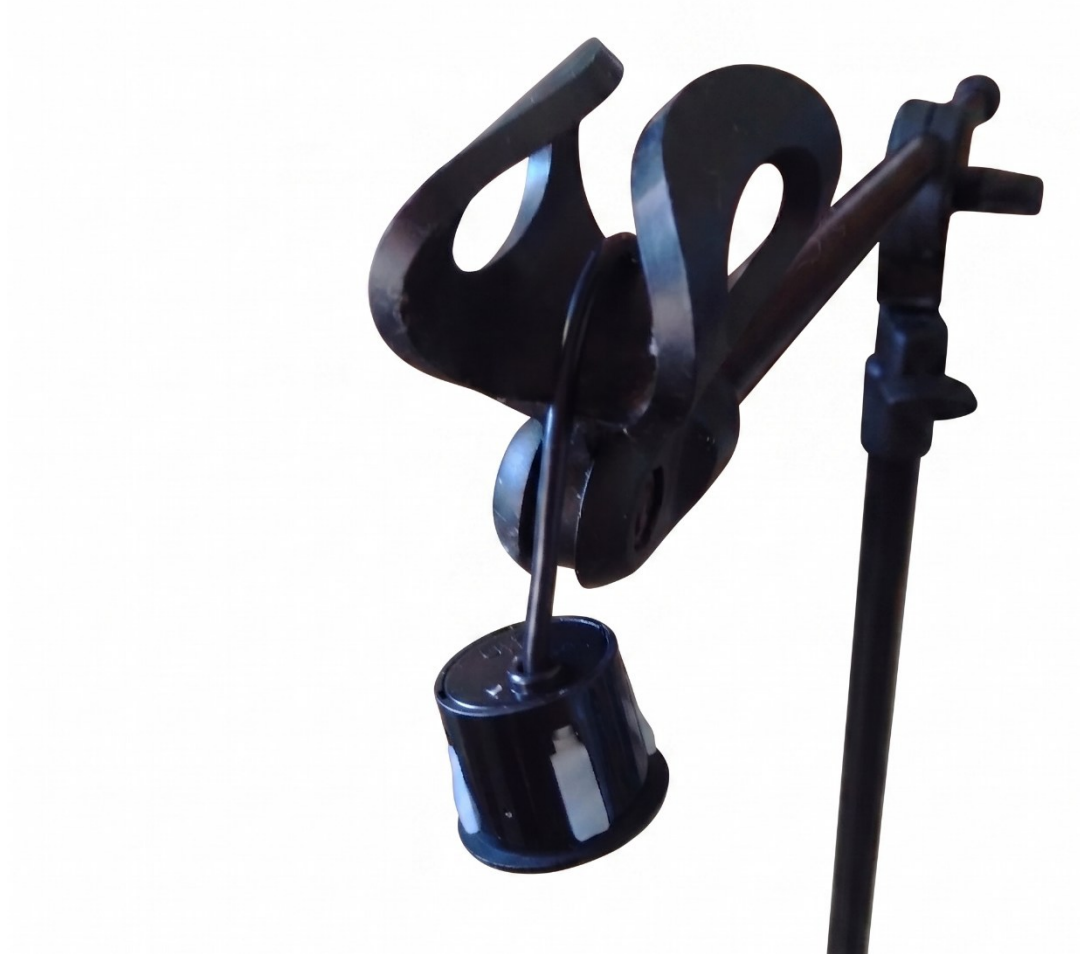
Figura 27 – Sensor ultrassônico utilizado e sua inclinação
