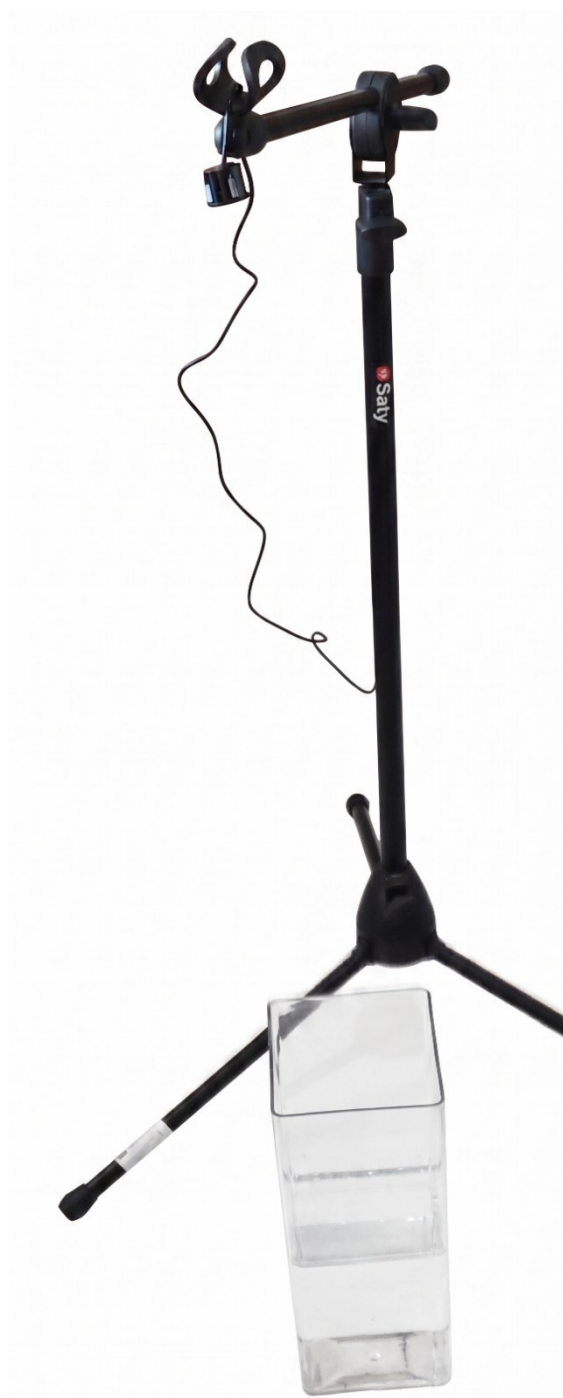
Figura 5 – Sensor ultrassônico instalado
