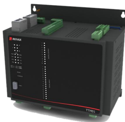
Figura 4 – Módulo TTM01: disparo e gerenciamento de retificadores
