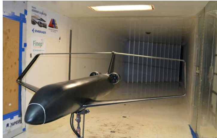
Figura 6 – Testes em túnel de vento de modelo em escala da aeronave INTI.
