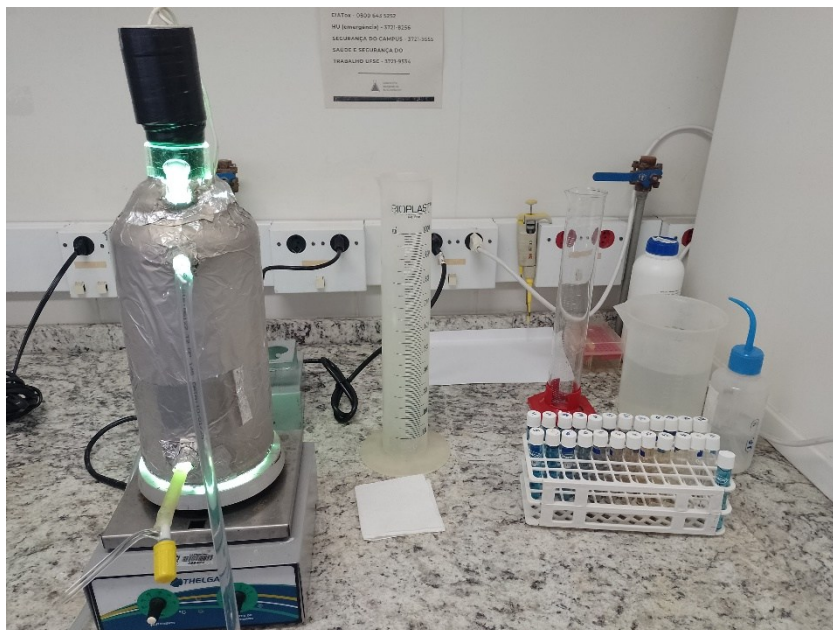
Figura 9 - Reator em funcionamento (esquerda) e alíquotas de efluente retiradas durante os ensaios (direita).
