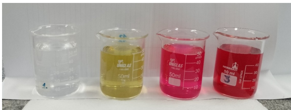
Figura 7 - Soluções padrão (da esquerda para a direita): Ácido Bórico (AB), (VB + AB), (VM + AB) e Mistura (VM + VB + AB)
