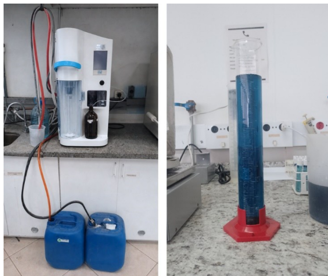
Figura 6 - Equipamento empregado na metodologia Kjeldahl (à esquerda) e efluente bruto (à direita).
