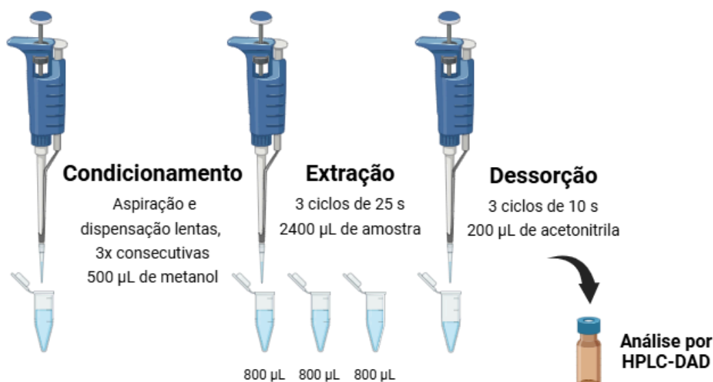
Figura 4 - Esquema do procedimento DPX para análise de filtros solares orgânicos em amostras de água.
