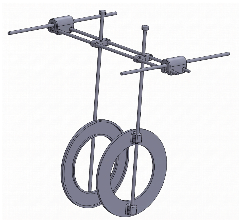
Figura 26 – Estrutura desenvolvida para permitir o controle do posicionamento das bobinas.
