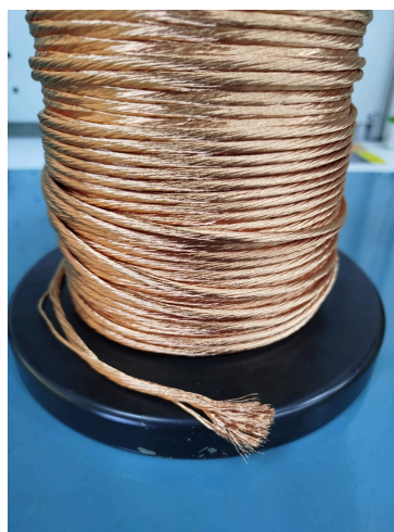
Figura 14 – Fio Litz utilizado na construção das bobinas.
