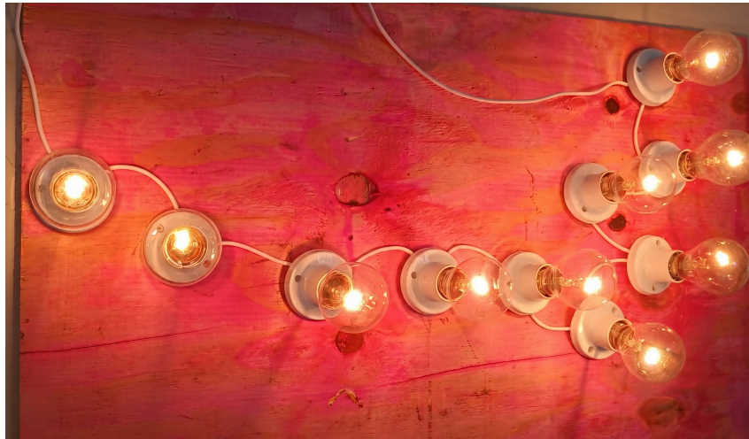
Figura 19 – Arranjo de lâmpadas construído para atingir o valor de 1,9 \Omega de resistência.
