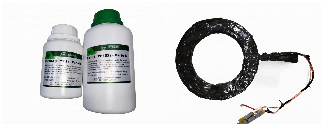
Figura 32 – Bobina encapsulada com resina epóxi para os testes em ambiente aquoso e a resina epóxi utilizada.
