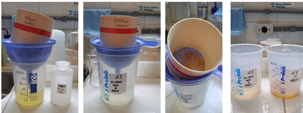
Figura 7 - Exemplo de separação das amostras nas frações D1 e D2. Legenda: O Projeto AtlantECO utilizou malha de 100 \mu\text{m} . Na presente pesquisa foi utilizada a malha de 200 \mu\text{m} .
