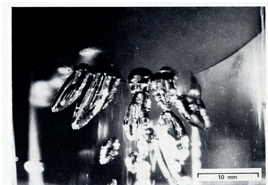
Figura 3.6 - Bolhas com diâmetro maior sob condição de baixa pressão Fonte: Bari e Hallett (1974)
