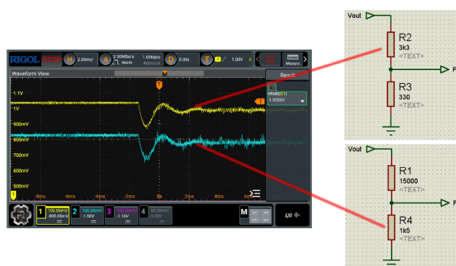
Figura 89 - Escolha dos resistores do divisor de tensão saída
