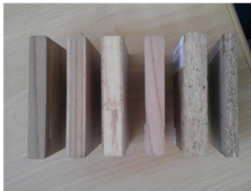
B - Seção transversal, em ordem: Teca, Compensado laminado, Compensado sarrafiado, Cinamomo, MDF, OSB e Bambu.
