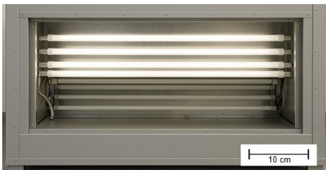
Figura 23 - Desenho ilustrativo da Câmara de envelhecimento.
