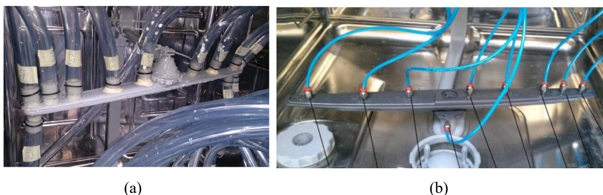
Figura 2.7 – Seção de testes para (a) medição da vazão dos orifícios de saída do braço e (b) medição de pressão em diferentes pontos do braço utilizada por Erik (2019) e Makowski et al. (2016).
