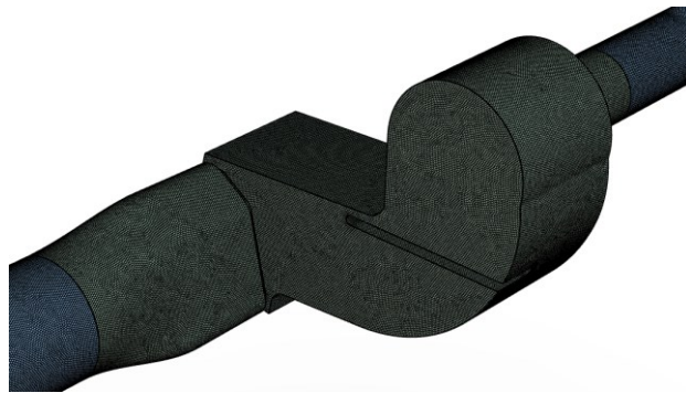
Figura 4.3 – Malha computacional poliédrica utilizada na simulação da geometria.
