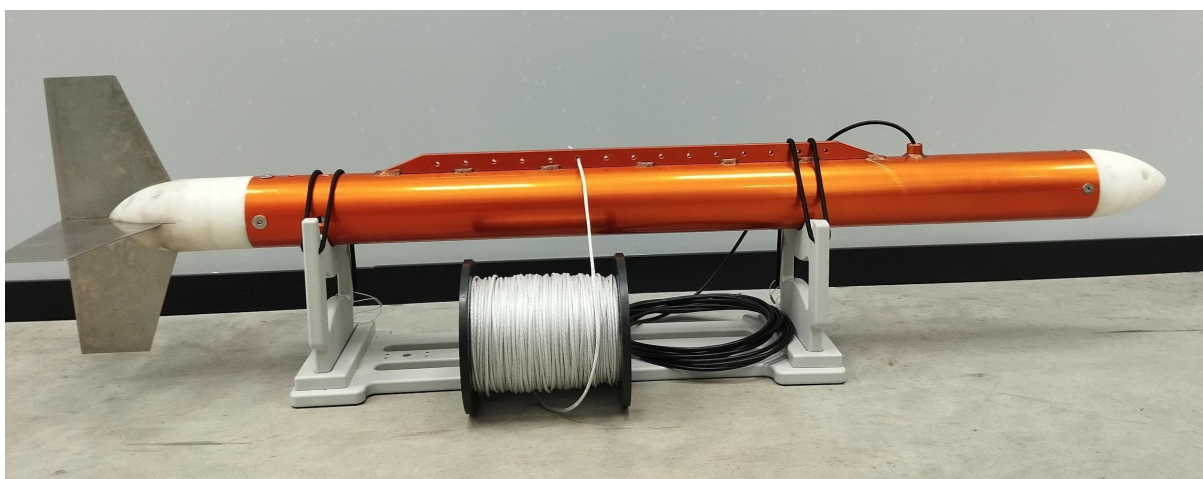
Figura 17 - Veículo rebocado subaquático construído no Lasub
