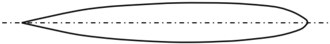
Figura 2 - Esquema da forma axissimétrica do casco em forma de lágrima
