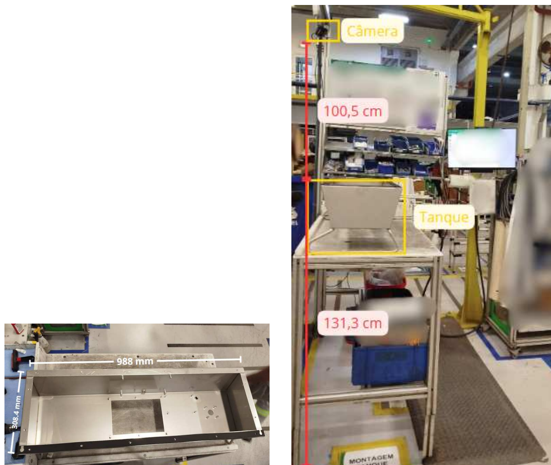
(a) Dimensões do tanque onde são montadas as borrachas inspecionadas.
