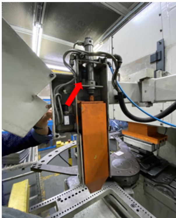
Figura 9 – Cilindro de fixação das peças - Sistema pneumático.
