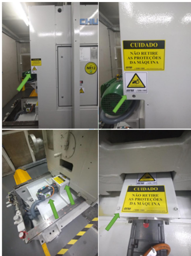
Figura 30 – Indicação das sinalizações de segurança na máquina.
