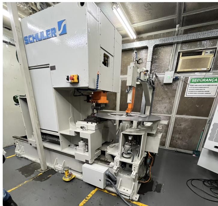
Figura 6 – Apresentação da Máquina: Prensa Hidráulica Ranhuradeira N25.
