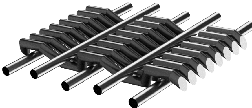
Fig. 28 – Arranjo de um trocador com canais complexos tridimensionais e retos
