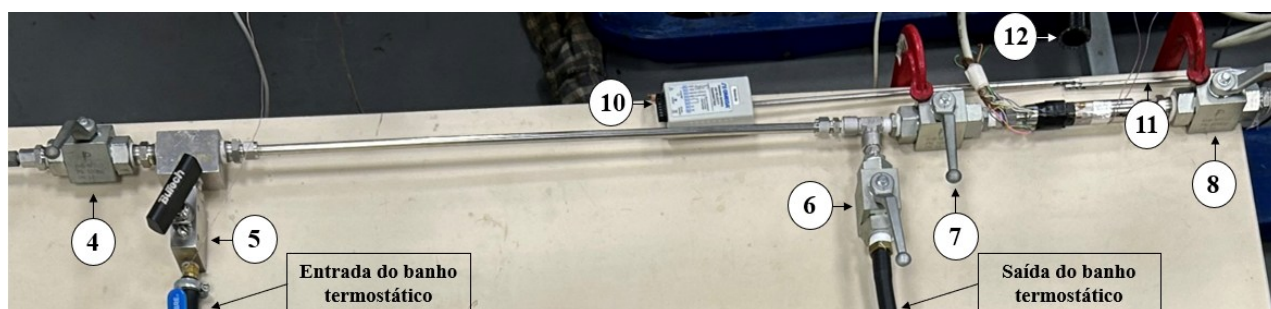
Fig. 15 – Aproximação da vista geral da bancada para melhor visualização das válvulas
