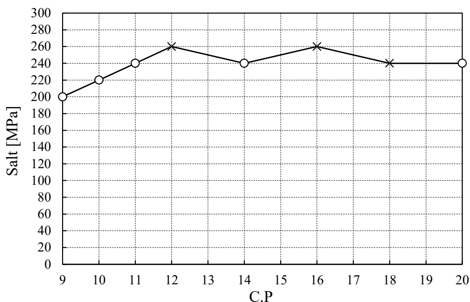
Fig. 67 – Avaliação da ruptura/vida infinita para cada corpo de prova em função da tensão alternada
