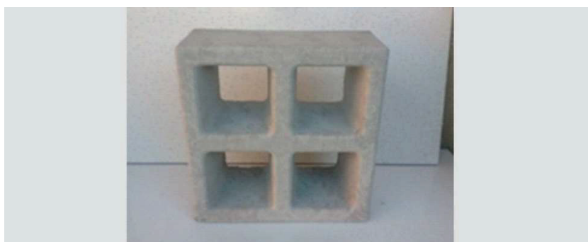
Figura 1: Cobogó produzido a partir do rejeito de granito. Fonte: Aguilar et al. (2018).
