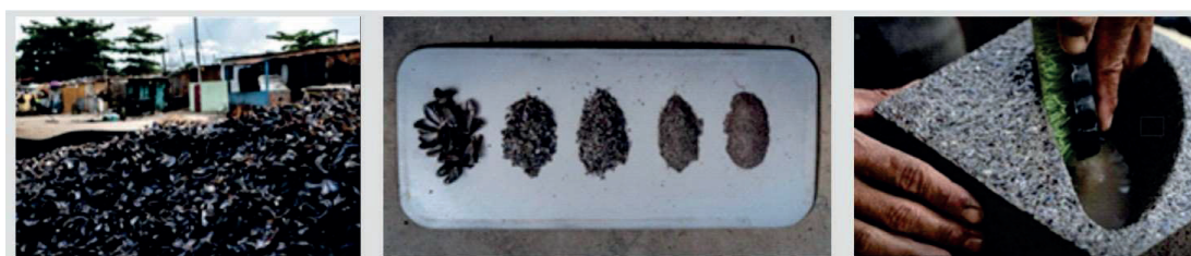
Figura 5: Casca do sururu descartada; fases de trituração da casca e a peça do Cobogó Mundaú. Fonte: Rosenbaum (Instagram).
