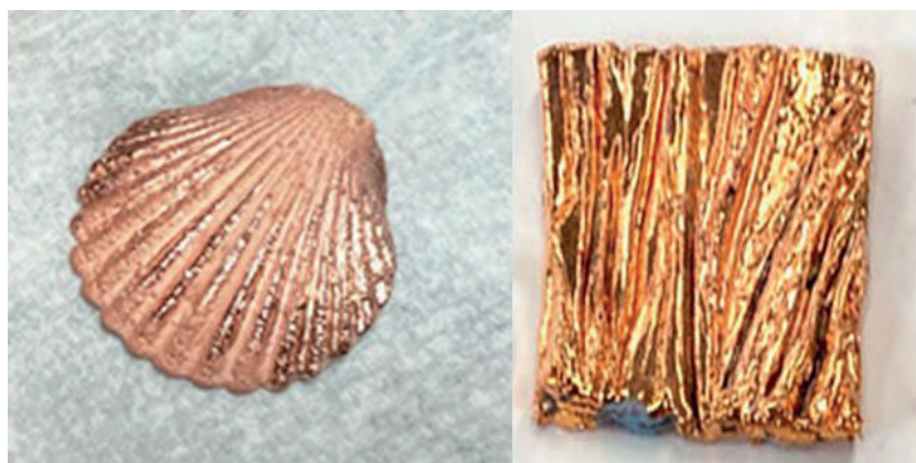
Figura 9: Metalização sem rugosidades. Fonte: Autores.
