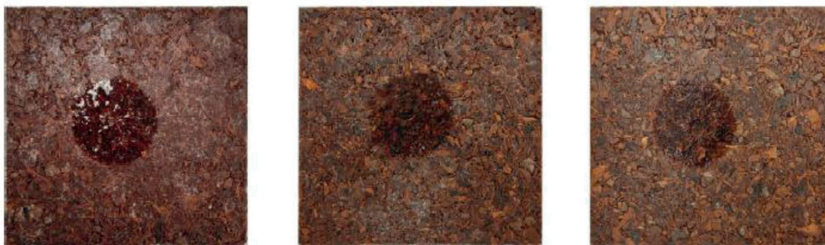
Figura 1: Ensaio de estanqueidade em amostras dos compósitos de pinha residual. Fonte: elaborado pelos autores.
