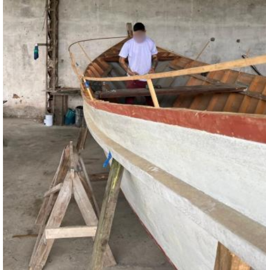
Figura 23 – Montagem dos gabaritos da nova borda livre
