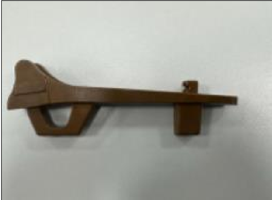
Figura 3 – Modelo em cera da peça com canais de alimentação
