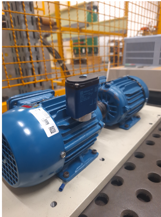
Figura 4.8 – Sensor fixado no motor de acionamento.
