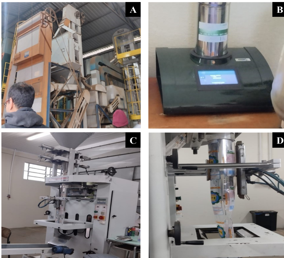
Figura 6 – A) Máquina de limpeza; B) Medidor de umidade; C) Empacotadora automática; D) Embalagens com a marca Terra Viva.
