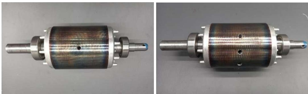
(a) Rotor com 1 barra rompida.
