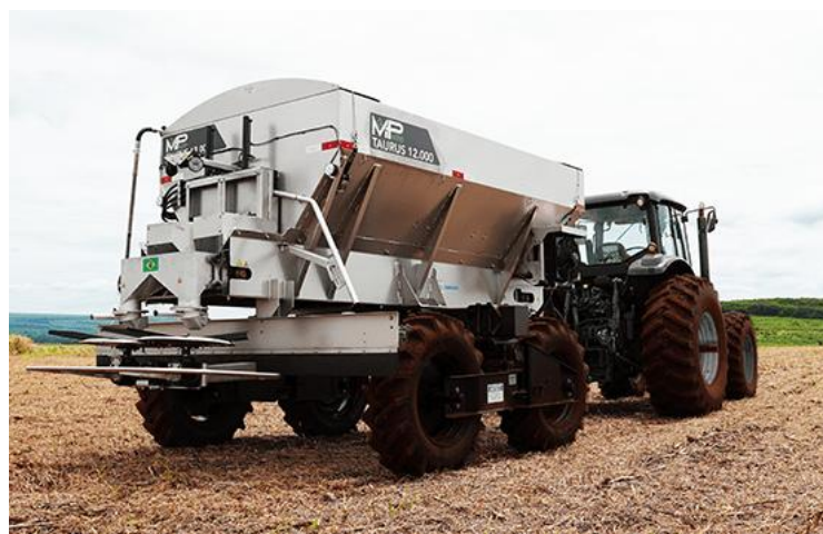
Figura 2 – Implemento de Distribuição à lanço de Arrasto MP Agro Taurus 12000
