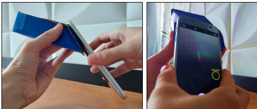
Figura 2.11: demonstração de como realizar o registro das fotos dos espectros.
