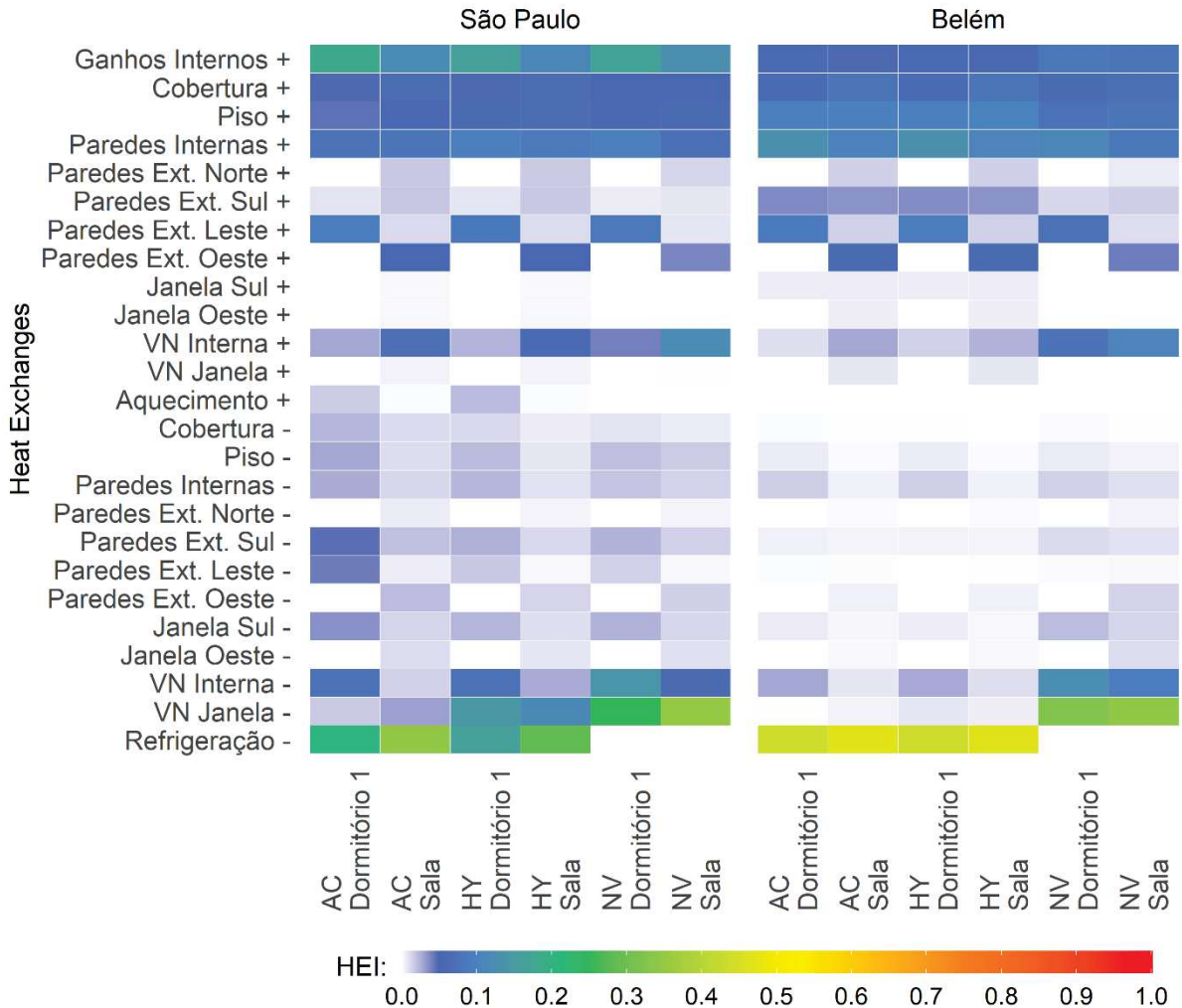
Figura 11 – Balanço térmico anual do ar do ambiente. AC: Ar-Condicionado; HY: Híbrido; NV: Ventilação Natural.
