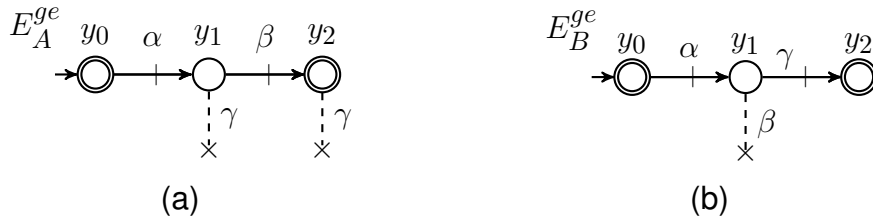
Figura 70 – Duas especificações gerenciais: (a) o evento \gamma é desabilitado depois das cadeias \alpha e \alpha\beta , (b) o evento \beta é desabilitado depois da ocorrência de \alpha .
