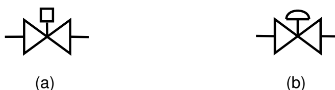
Figura 37 – Simbologia em Diagramas ISA: (a) válvula de bloqueio, (b) válvula de controle.
