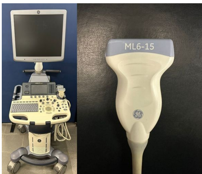
Figura 1 - A esquerda- imagem do US (GE LOGIQ S7 Expert, General Electric, EUA). A direita- imagem do cabeçote de matriz linear usado para captar as imagens (Fonte: próprio autor).
