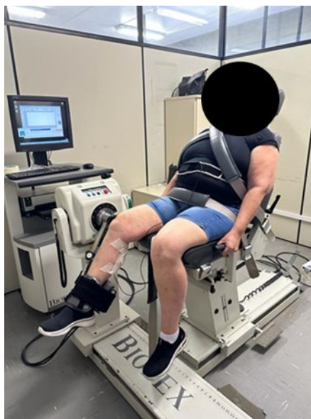
Figura 7 - Participante sentada no BIODEX para realização de contrações máximas isométricas de extensão de joelho (Fonte: próprio autor).
