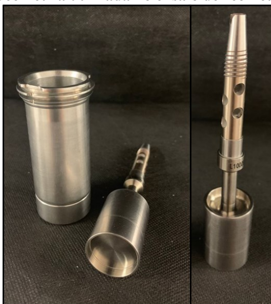
Figura 13 - Geometria utilizada no ensaio de reometria rotacional
