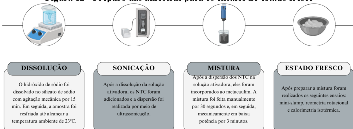
Figura 12 - Preparo das amostras para os ensaios no estado fresco
