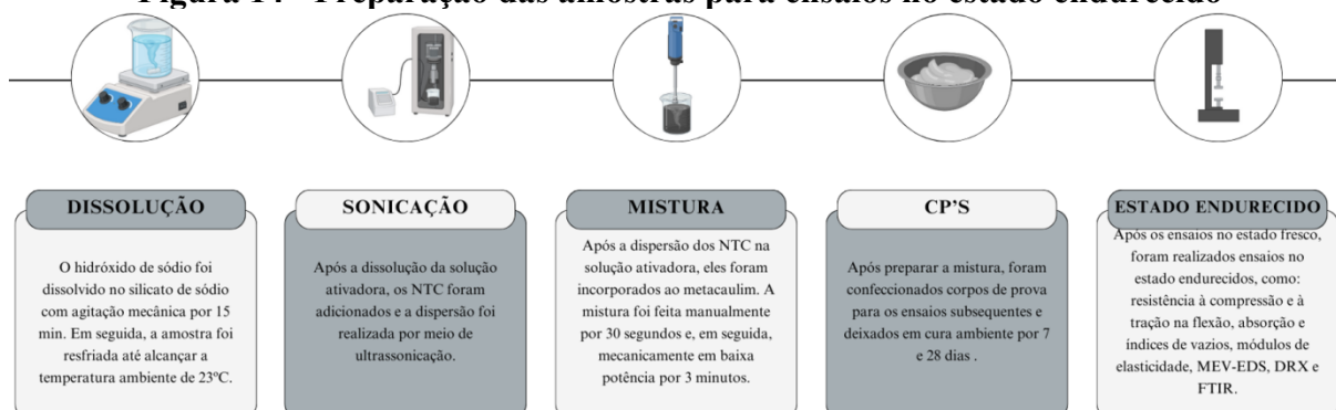
Figura 14 - Preparação das amostras para ensaios no estado endurecido
