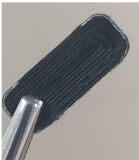
Figura 47 – a) Peça impressa com 1 % em massa de NTC; b) análise de condutividade pela placa 1; e, c) análise de condutividade pela placa 2
