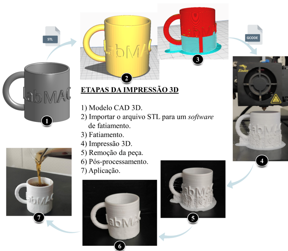
Figura 2 – Detalhamento ilustrativo das etapas de prototipagem de uma peça para a impressão do tipo FDM
