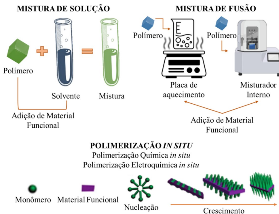
Figura 4 – Estratégias de mistura de polímero com material funcional usando os métodos de mistura ou polimerização in situ
