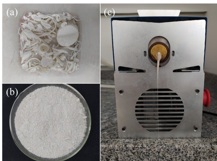
Figura 17 – Material compósito produzido com PLA e ZnO via misturador interno: (a) mistura resultante após processo de fusão no reômetro; (b) grânulos obtidos pela moagem em moinho de facas; e, (c) filamento sendo extrudado
