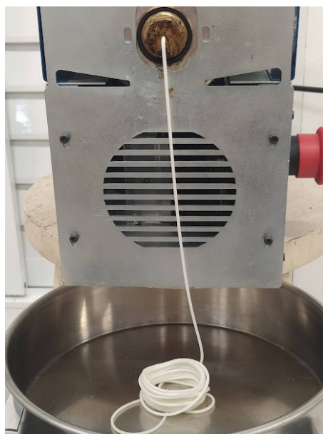
Figura 38 – Extrusão de filamento fotocatalítico para uso em impressora FDM
