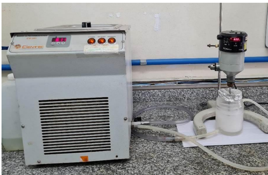
Figura 18 - Reator com temperatura controlada para síntese de microcápsulas
