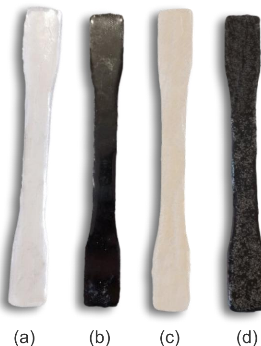
Figura 19 – Amostras produzidas: a) Resina epóxi pura; b) EP/NTC; c) EP/ PUF-PDMS-a; d) EP/PUF-PDMS-a/NTC
