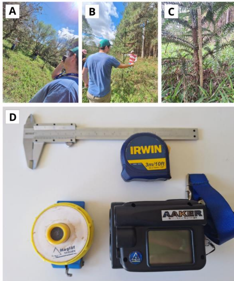
Figura 1 – (A) Medição de altura com hipsômetro; (B) Medição do diâmetro de copa; (C) Medição de altura de fuste com trena graduada; (D) Paquímetro, trena graduada e hipsômetro Vertex.
