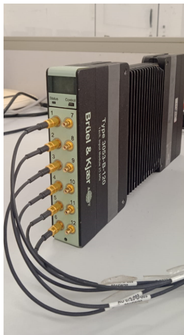
Figura 6 – Placa ADC utilizada no experimento para captura de dados. Fonte: do Autor
