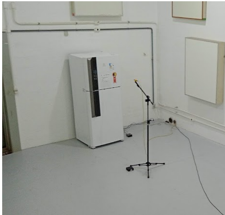
Figura 13 – Posição do microfone em relação ao refrigerador. Fonte: do Autor.
