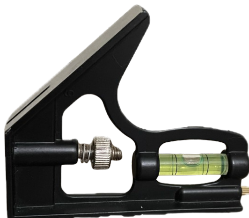
Figura 20 – Nível de bolha com inclinação de 45°.
