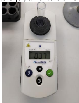
Figura 3. Processo de ajuste de densidade óptica de suspensão bacteriana de Neisseria gonorrhoeae em tubo de ensaio acoplado ao equipamento bioMérieux VITEK® DensiCHEK® plus
