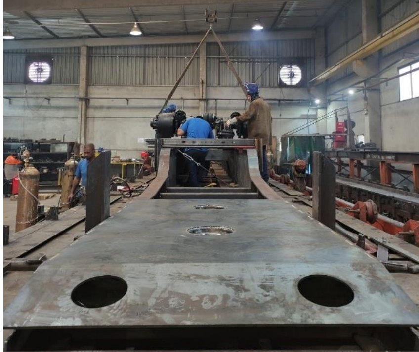
Figura 20 – Início de montagem da base de semirreboque
