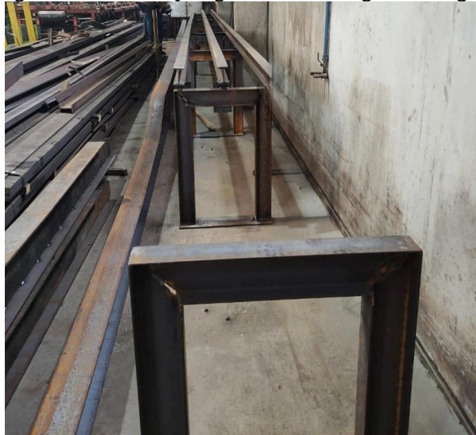
Figura 29 – Produção gabarito montagem de vigas
