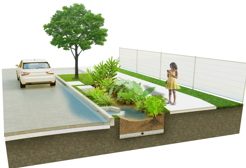
Figura 5: Zona de biorretenção
