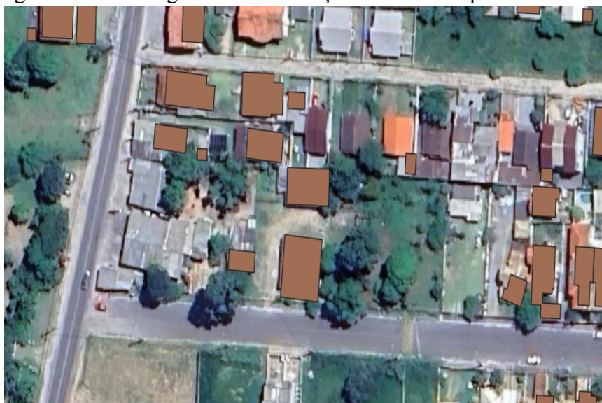
Figura 26 – Defasagem na identificação das áreas impermeabilizadas
